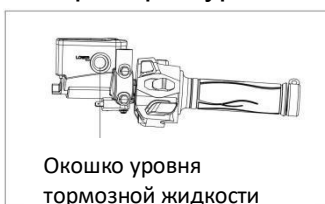
Рисунок 26 Проверка уровня тормозной жидкости переднего тормоза
