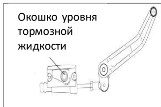
Рисунок 30 Проверка уровня тормозной жидкости заднего тормоза
