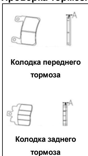
Рисунок 29 Проверка фрикционной колодки заднего тормоза
